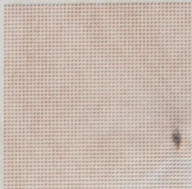
origine pattern (o.p.) : square, 0,5 mm, espacing, 0,5 mm, forming a square, 60 mm.
